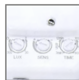
réglage du capteur LUX / SENS / TIME
