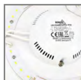
nouvelle alimentation isolée
